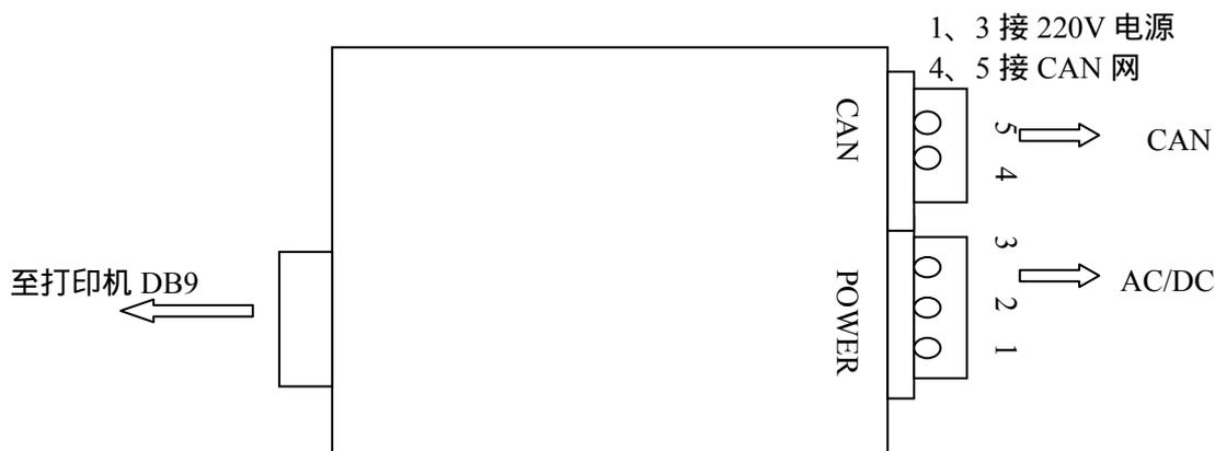
打印机接口装置外形图
